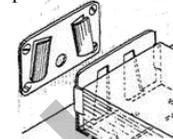
Рис. 7 – Соединение фиксатором SISO H-69
