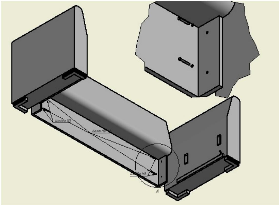
2. Далее необходимо присоединить верхнее сидение к боковинам. При помощи болта М8\*55 и шайбы М8 прикрутить сидение к боковине через металлические уголки, установленные на обратной стороне верхнего сидения:
