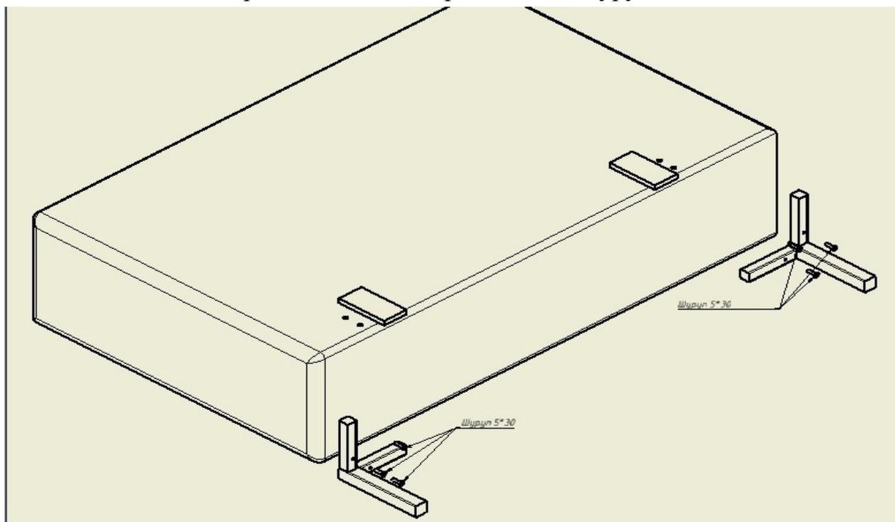
2. Присоединить боковины к центральному модулю при помощи болтов М8\*55 и шайб М8.
