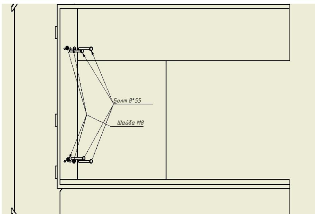
3. Соединить откидную спинку-сидение к основанию. Это делается с помощью петли, установленной на откидной спинке:
