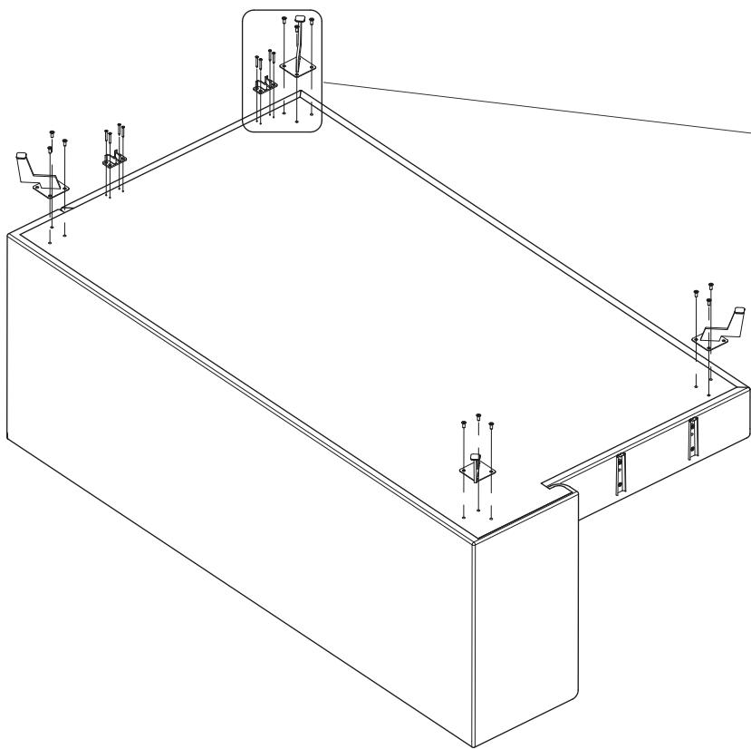
Опоры А прикрутить к модулю в соответствии с эскизом, используя винты С. Винты закручивать отверткой со шлицом Pz3.
