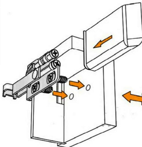
Регулировка по высоте, 13 мм
