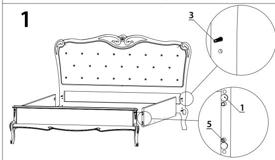
Для предотвращения скрипа приклейте на торцы царг по 2 опоры самоклеющиеся поз.1 (выровнять по внутренней плоскости царги) смотреть схему.
