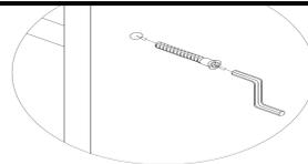
Рис. 6 - Соединение винтом-конфирматом
