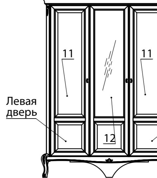
Навесьте двери поз.11 на шкаф следуя инструкции. Отрегулируйте положение дверей по инструкции.
