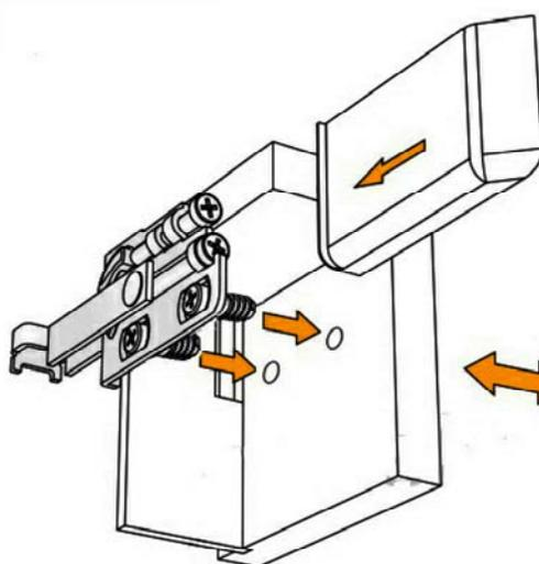
Регулировка по высоте, 13 мм
