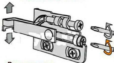
Регулировка по глубине, 17 мм
