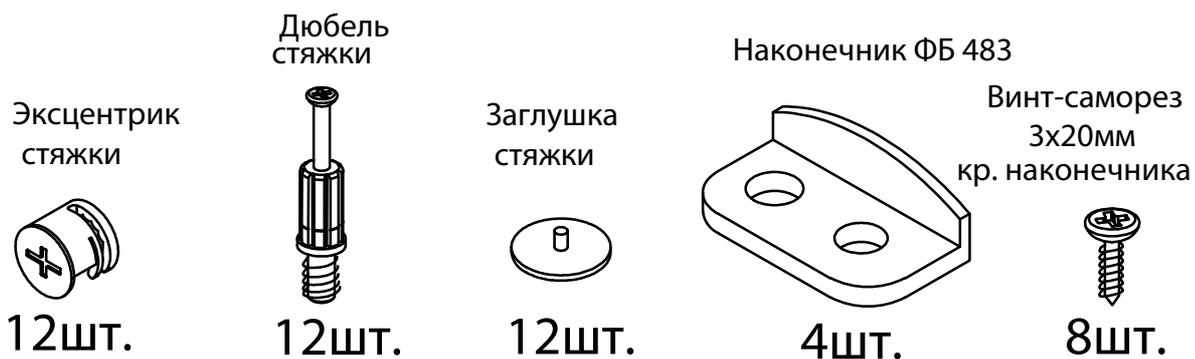
1. При помощи винта самореза 3x20 крепим наконечник к опоре (поз.2)
