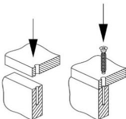
Рис. 5 –Установка винтов-конфирматов
