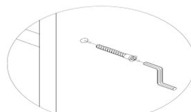
Рис. 5 - Соединение винтом-конфирматом
