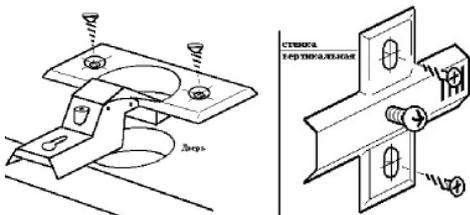
**ВНИМАТЕЛЬНО СМОТРЕТЬ ПЕРЕЧЕНЬ ФУРНИТУРЫ И СХЕМУ СБОРКИ!** Прикрепить петли согласно схемы сборки на дверь (6) шурупами-саморезами 3,5x16, придерживая дверь отрегулировать её в проёме по зазорам и прикрутить ответные платы петель шурупами-саморезами 4x16мм к боковой стенке (1) или (2) изнутри шкафа (Рис.7). Полностью отрегулировать
