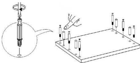
Рис. 3 - Установка шкантов и штоков эксцентриков
